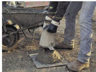
Prova di Slump
